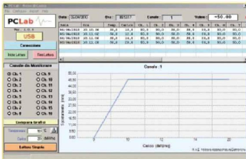
Software dedicato alla visualizzazione ed archiviazione di dati acquisiti durante prove di carico su solai o altri elementi portanti effettuate con strumentazione Novatest
